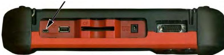
Abbildung 2-6 Position des SOLUS PRO USB-Anschlusses (Beispiel)
