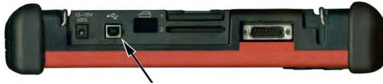
Abbildung 2-5 Position des SOLUS USB-Anschlusses (Beispiel)
