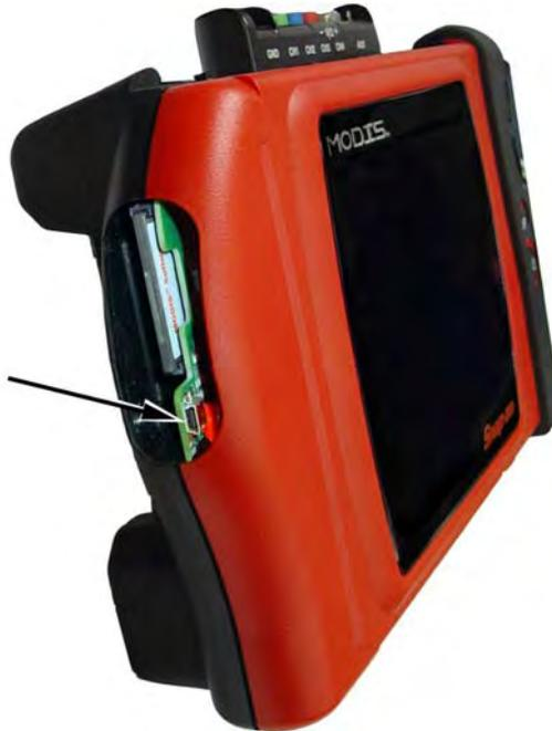
Abbildung 2-3 Position des MODIS USB-Anschlusses (Beispiel)
