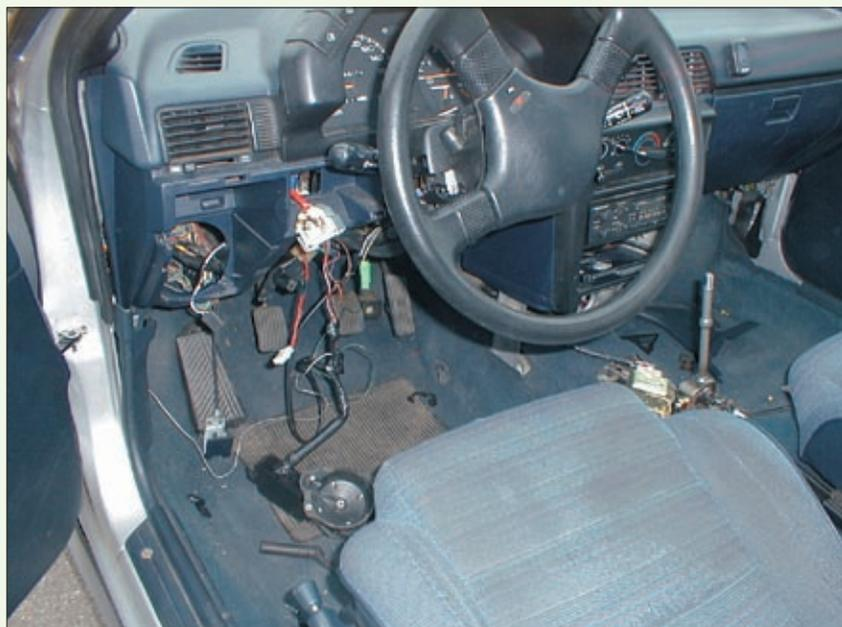
*Bild 1: Häufig sieht der Arbeitsplatz eines Diagnostikers so aus, wenn ihn die menügeführte Diagnose in die Irre geführt hat. In diesem Fall hatte der „allgemeine Diagnosebegleiter“ entschieden, der Fehler liege eindeutig in der Elektrik. Tatsächlich hat der Verteiler die Positionssignale aufgrund eines gerissenen Steuerriemens nicht gesendet – ein möglicher Fehler, der bei der Programmierung der geführten Fehlersuche niemals berücksichtigt wird.*
